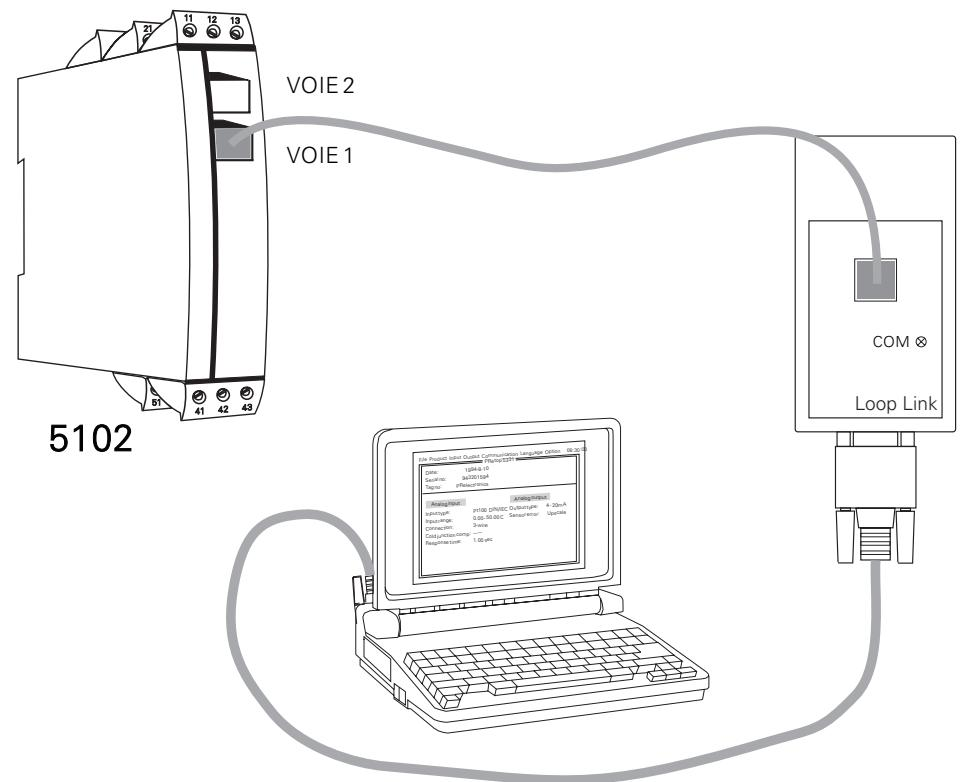
N.B.: La programmation peut être effectuée avec l'alimentation connectée ou déconnectée. Si l'alimentation est connectée pendant la programmation, le module doit être débranché et puis rebranchée quand la programmation a été achevée.
