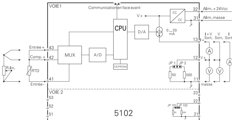
Pour un capteur raccordé en 2-fils, les bornes 42 et 43 doivent être mises en court-circuit
