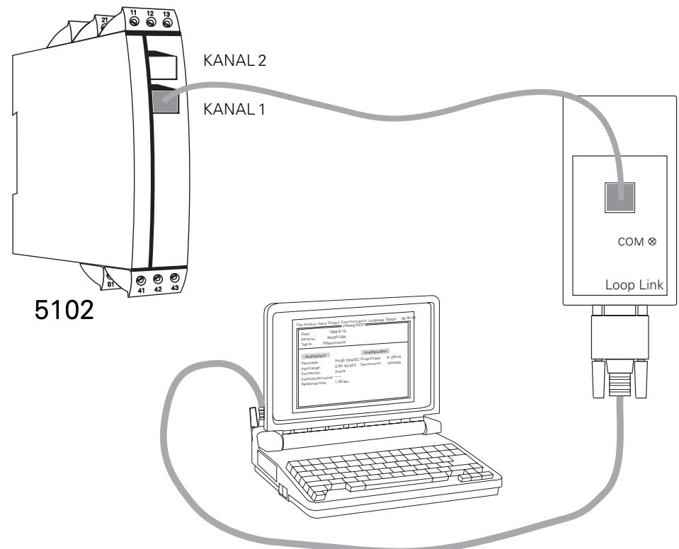
Das Modul kann ohne Versorgungsspannung und unter Spannung programmiert werden. Wird das Gerät unter Spannung programmiert, muss nach der Programmierung das Modul durch trennen der Versorgungsspannungsanschlüsse zurückgesetzt werden.
