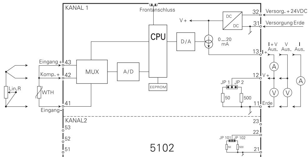
Wird ein 2-Draht-Anschluss gewünscht, müssen die Anschlüsse 43 und 42 im Anschlussstecker kurzgeschlossen werden.
