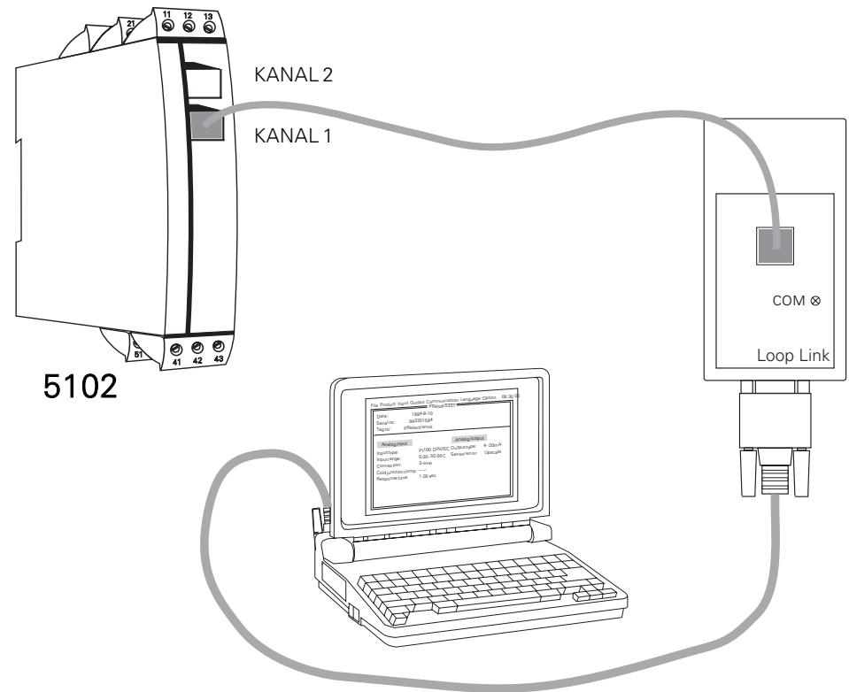
NB: Enheden kan programmeres med eller uden tilsluttet forsyning. Hvis enheden programmeres med tilsluttet forsyning, skal den afbrydes og tilsluttes igen efter endt programering.
